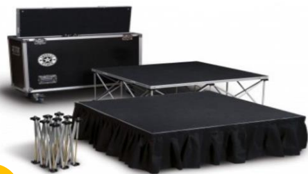
Podiums de scène démontables ultracompacts (avec une mise en œuvre rapide et sans outil) : Capacité de 900 KG par M2, Hauteur de 20 à 160 cm, plus de 90m2 de scène
